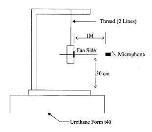
1 METER FROM MICROPHONE TO FAN INTAKE
